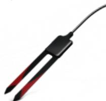
**Tensiometro**, sensore che misura lo sforzo delle radici per estrarre l'acqua dal terreno, utile per ottimizzare l'irrigazione e i trattamenti.
